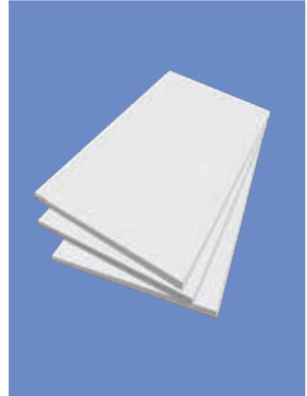
**Eterboard** es una placa plana de fibrocemento fabricada con la más avanzada tecnología, a base de cemento Portland, sílice, fibras naturales y aditivos, los cuales mediante un proceso de autoclavado se someten a altas presiones y temperaturas, obteniéndose un producto con un inigualable nivel de estabilidad dimensional y resistencia que lo hacen tan fácil de trabajar como la madera conservando las propiedades del cemento.
